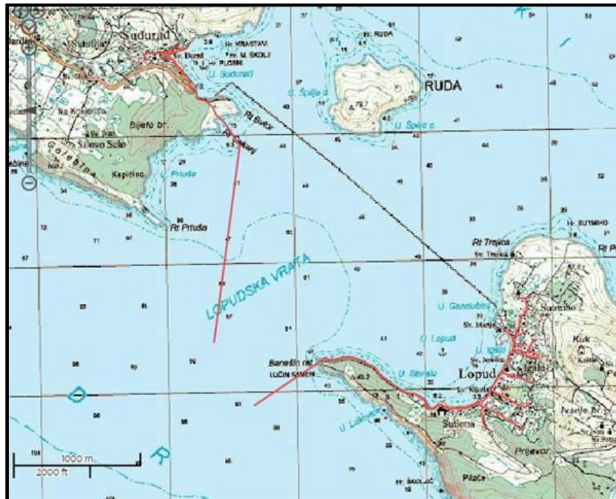
Slika 4.1-1. Položaj podzemskih ispusta sustava odvodnje i pročišćavanja naselja Suđurađ i sustava odvodnje i pročišćavanja otoka Lopuda
