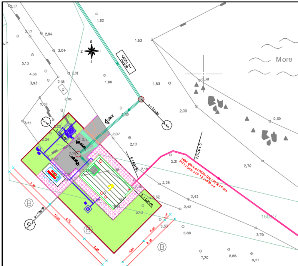
Slika 2.3-6. Situacijski prikaz UPOV-a Suđurađ (izvor: Hidroprojekt-ing, 2016.)
